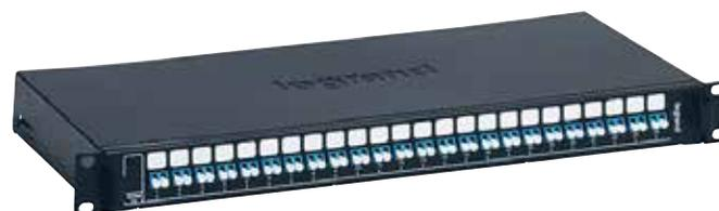
**Cassetto ottico equipaggiato scorrevole:** arresto a fine corsa con inclinazione a 30°. Capacità massima: 24 ST e SC, 48 LC.
